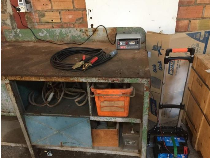
Un chariot batterie est mis à disposition dans le hangar pour permettre les briefings cockpit et l'assistance au démarrage en cas de défaillance de la batterie de bord (déchargée).
