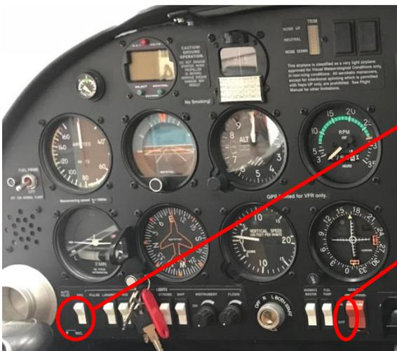
La commande EPU permet de connecter l'alimentation EXT au réseau de bord de l'avion (*même sans mettre la batterie de bord de l'avion sur ON*)
