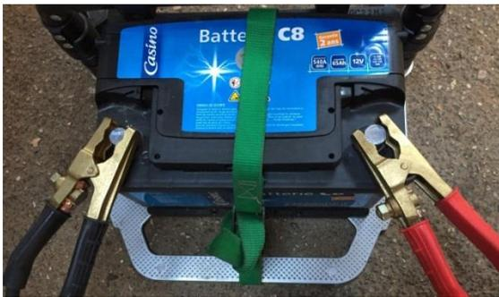
**RACCORDER LE CABLE AVION A LA BATTERIE EN RESPECTANT LES POLARITES**
