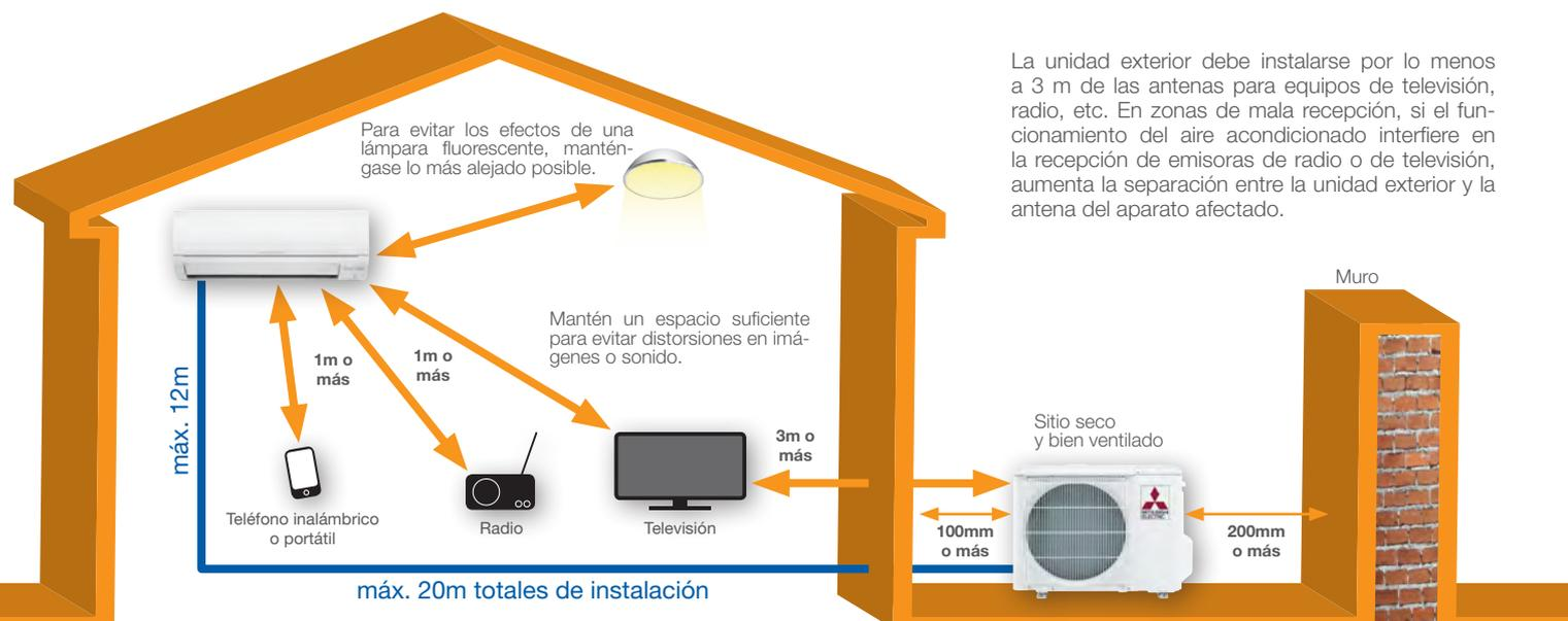
La unidad exterior debe instalarse por lo menos a 3 m de las antenas para equipos de televisión, radio, etc. En zonas de mala recepción, si el funcionamiento del aire acondicionado interfiere en la recepción de emisoras de radio o de televisión, aumenta la separación entre la unidad exterior y la antena del aparato afectado.
