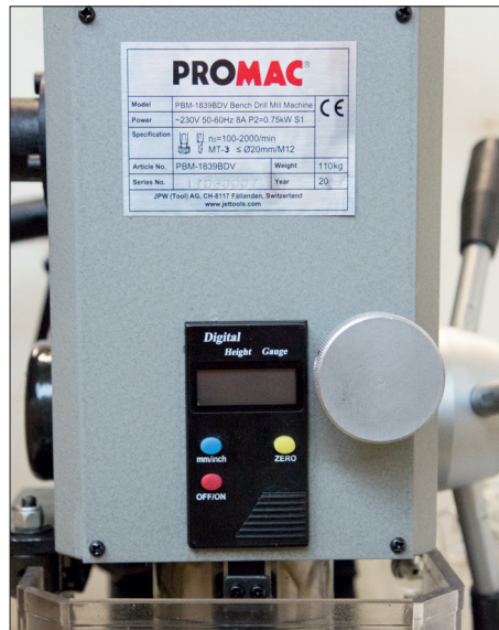
Die Bohrtiefenanzeige ist digital
