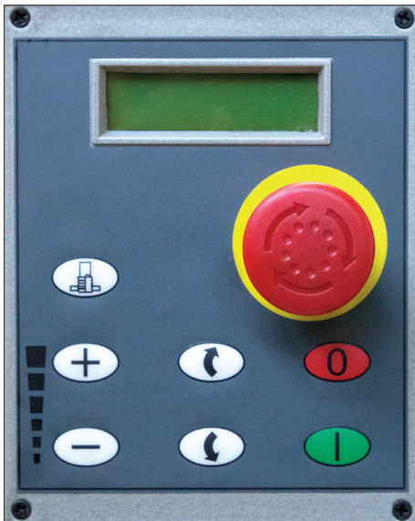
Hier werden Geschwindigkeit und Drehrichtung der Fräse eingestellt
