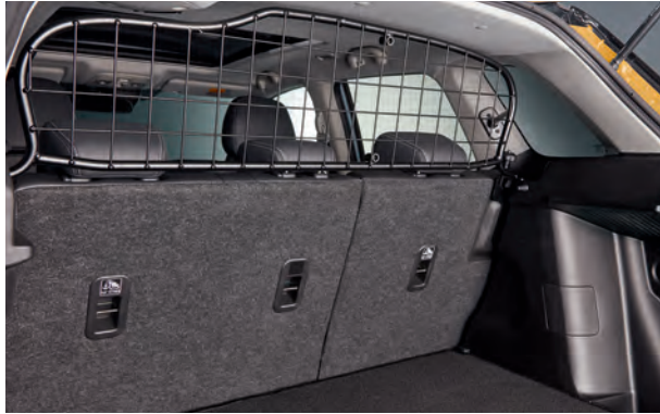
10 | Gepäckraumtrenngitter „Basic“ * zur Trennung der Rücksitzbank und des Gepäckraumes, aus Stahl gefertigt, einfache Montage ohne Bohren Art.-Nr. 990E0-54P48-000
