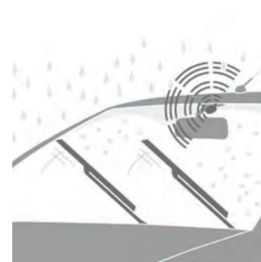
25 | Regensensor reagiert vollautomatisch auf Regen und steuert die Wischintervalle Art.-Nr. 990E0-65J81-035
