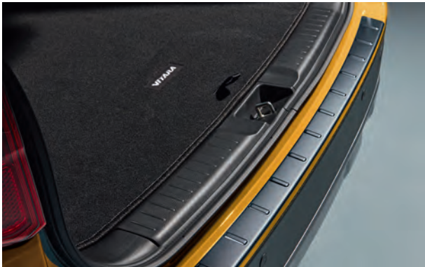
16 | Ladekantenschutz schwarz, aus strapazierfähigem Thermoplast, schützt hintere Stoßstange beim Be- und Entladen Art.-Nr. 990E0-54P51-000
