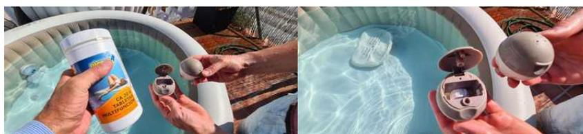
Der Filter muss bei Benutzung **täglich** ausgespült werden. Dazu dreht man den unteren Filter ab, schraubt ihn auf und spritzt ihn gründlich ab. Dafür gibt es überall Wasseranschlüsse mit Schläuchen.
