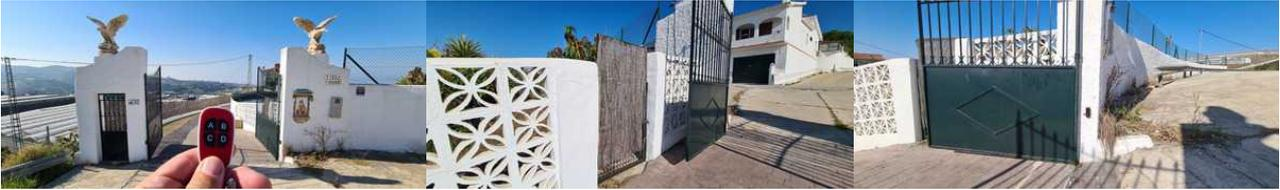
Das Einfahrtstor geht mit einer Funkfernbedienung auf. Auf der Fernbedienung die Taste „1“ drücken und warten, bis das Tor sich komplett geöffnet hat. Es schließt automatisch nach einer bestimmten Zeit, wenn der Sensor freigegeben ist. Der Sensor prüft, ob sich noch ein Fahrzeug in der Lichtschranke befindet und wartet dementsprechend.
