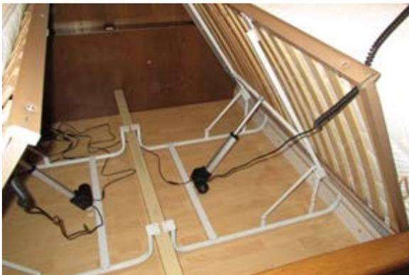
**Bild 2:** Matratzenheber eingebaut in (Doppelbett)
