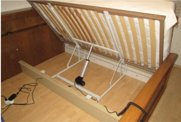
**Bild 1:** Matratzenheber eingebaut (Einzelmontage, bzw. in Einzelbett)
