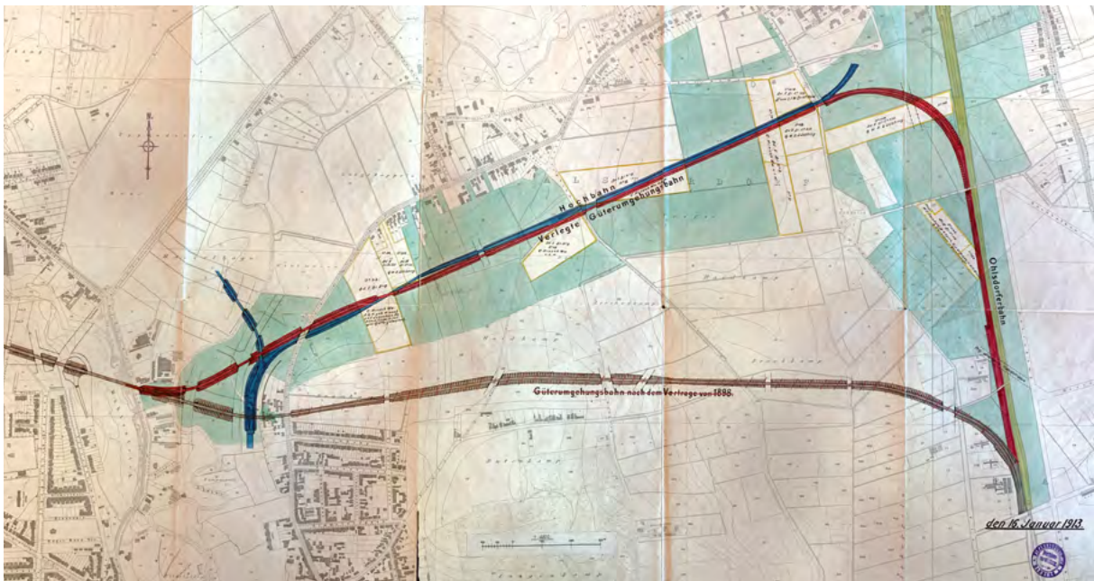
Trassenplanungen für die Güterumgehungsbahn 1903 (Abb. oben) und 1913 (Abb. unten).
