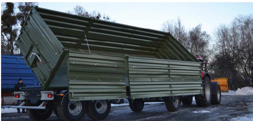
Der Drehschemel Dreiseitenkipper 3TSP-24T hat zusätzliche Stützen links und rechts, die den Aufbau verstärken damit sich die Seitenwände nicht verwinden.
