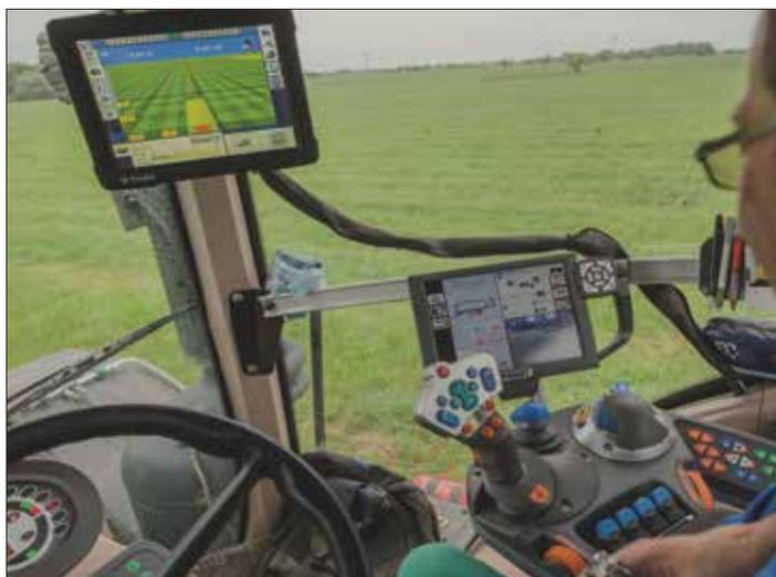
Ein Schlepper der neuesten Generation ist wirklich nichts für Feiglinge und Technikverweigerer. Wie im Cockpit einer Boeing sieht es bald aus. GPS-Signale steuern Ausbringungsmengen, Spurfahren und Geräteeinstellungen.
